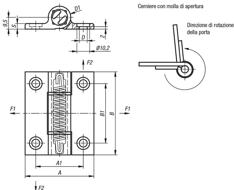
**Cerniere a molla Cerniere con molla di trazione, profilo di alluminio 1,3
